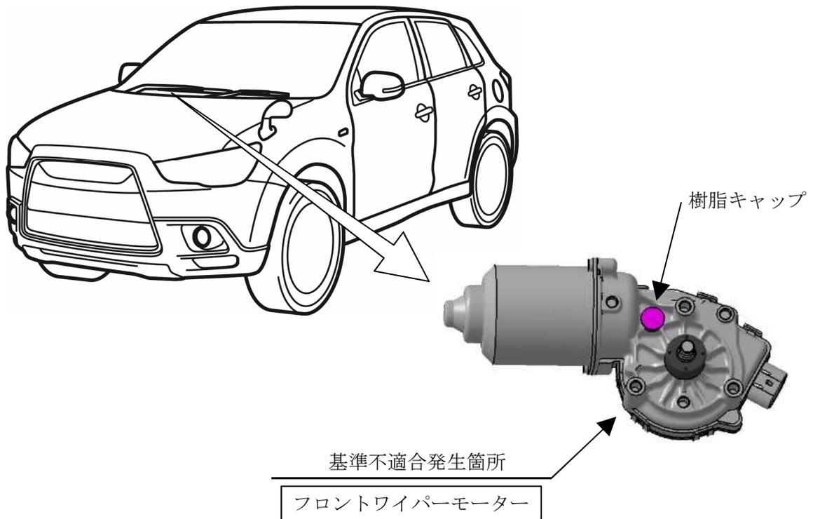
フロントワイパーモーターにおいて、フロントデッキ部の防水構造が不適切なため、フロントデッキガーニッシュとウインドシールドガラスの間から伝った水がモーター内部に浸入し、モーターの内部が腐食することがある。そのため、最悪の場合、ワイパーモーターが作動しなくなるおそれがある。
