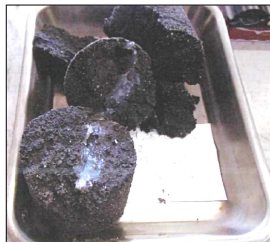
写真-2.1 割裂注入の痕跡を示す試料 (今回のサンプリング結果 No. 2 深度-9.1m)
