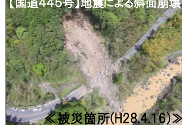
写真① 【国道445号】地震による斜面崩壊
