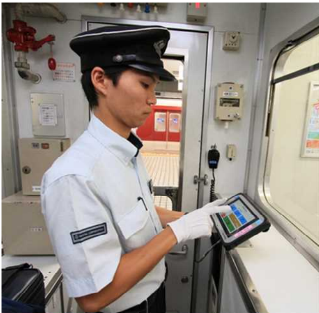
車掌が携帯し、乗務時に車両の放送回路に接続して使用
