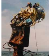
損傷した浮体式灯標
