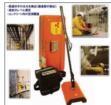
図-2.7 中性子水分計 (MCM-2 型 Hydotecto)
