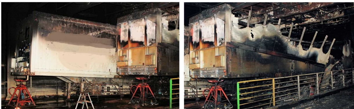
写真5 第3甲板右舷中央部に積載されていた車両の損傷状況
