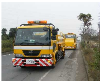
下水処理水等を活用した路面清掃
