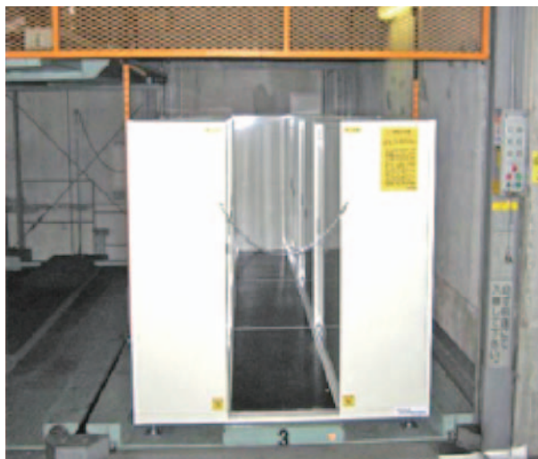
搬器上に倉庫を設置した例
