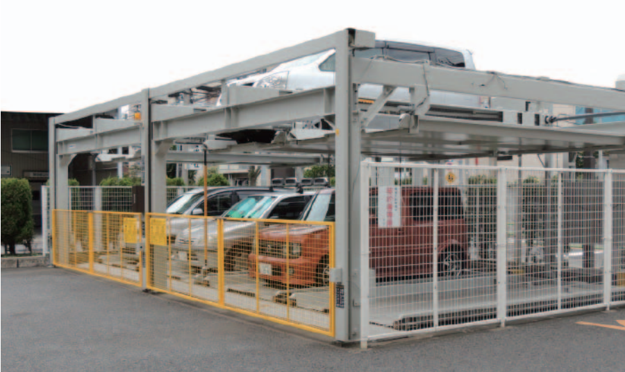
前面ゲートと柵を設けた機械式駐車装置の例
