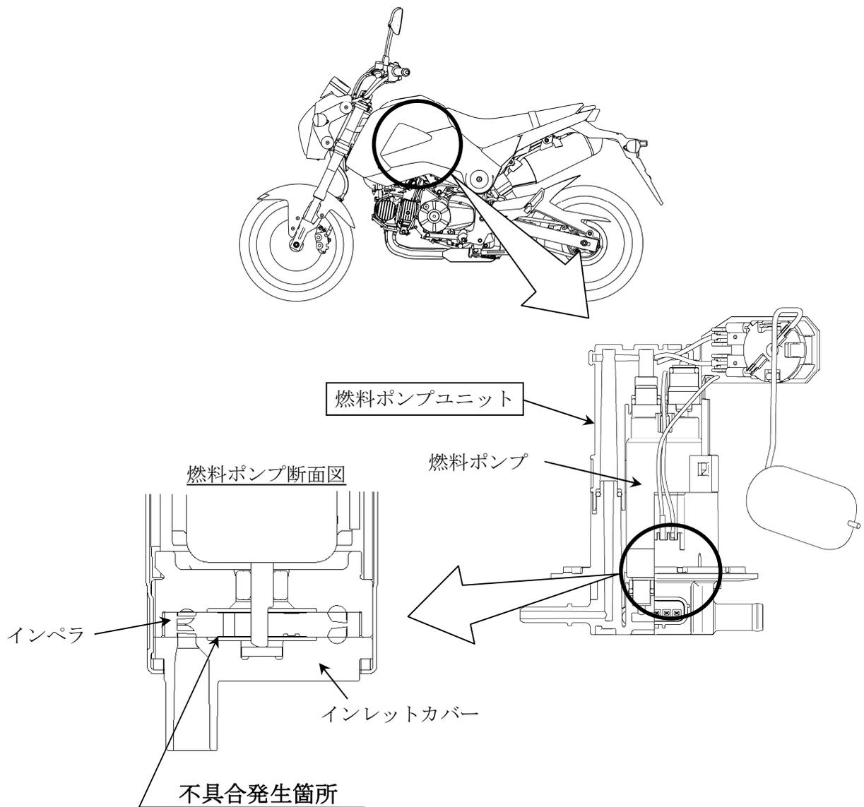
燃料ポンプ内の樹脂製インレットカバーの材質が不適切なため、製造時に使用した試験油に長時間浸漬されると、使用過程において、当該インレットカバーが膨張し、インペラと干渉することがある。そのため、干渉部の抵抗が大きくなり、干渉部から生じた磨耗粉がインレットカバーとインペラ間に噛み込むと、最悪の場合、燃料ポンプが停止してエンストし、再始動できなくなるおそれがある。
