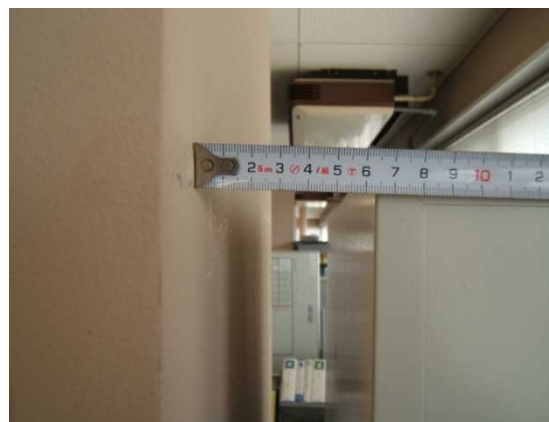
執務室内：キャビネット(H1,690mm) 上部開き(65mm)→床の傾斜度約1/25
