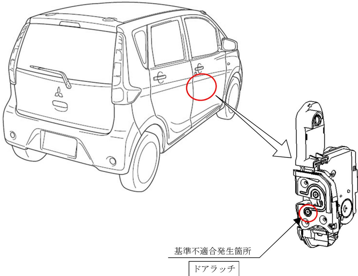
右側乗降扉のドアラッチにおいて、構成部品の製造が不適切なため、部品の精度が規格を外れているものがあり、気温が高くなるとロック機構の動きが悪くなることがある。そのため、乗降扉が確実にロックされず、最悪の場合、運行中に乗降扉が開くおそれがある。
