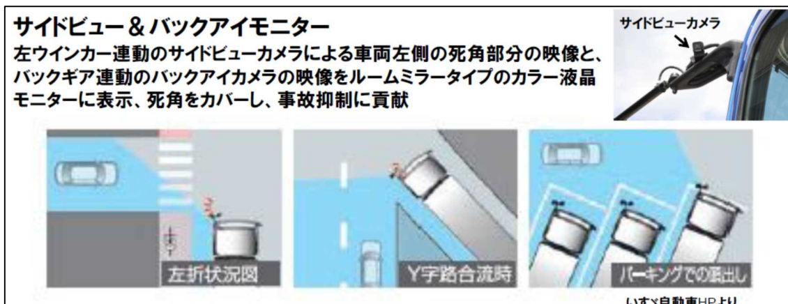
図 3-2-5 カメラモニタリングシステムを活用した大型車の視野拡大
