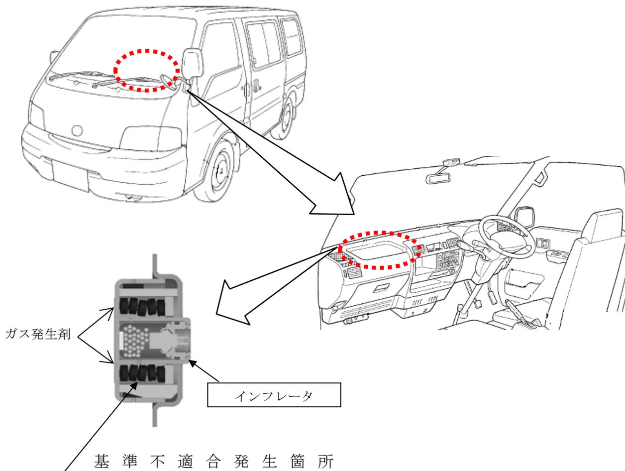
助手席側エアバッグのインフレーター（ガス発生装置）において、ガス発生剤が湿気のある状態で長期間の温度変化にさらされると劣化することがある。このため、エアバッグ展開時にインフレーター容器が破損して構成部品が飛散し、乗員が負傷するおそれがある。
