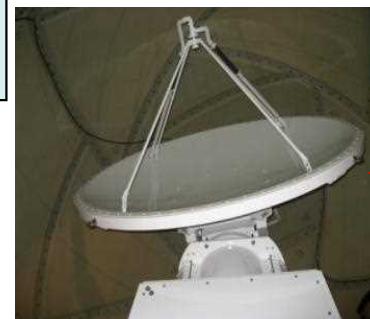
XバンドMPLレーダ雨量計 (アンテナ直径:約2m)
