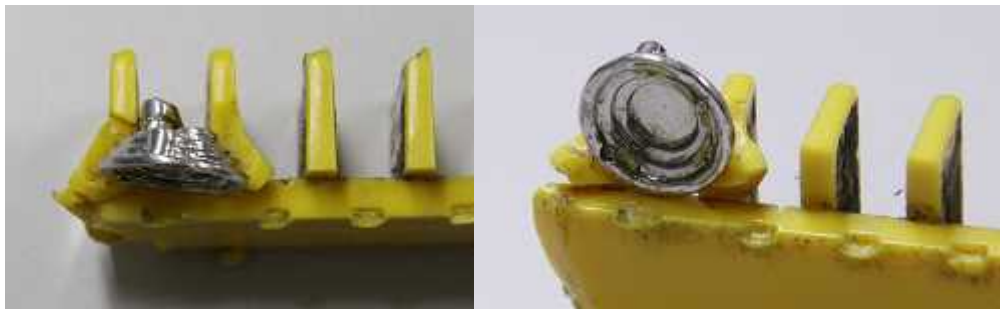
写真23 異物とデマケーションコムの破損部
