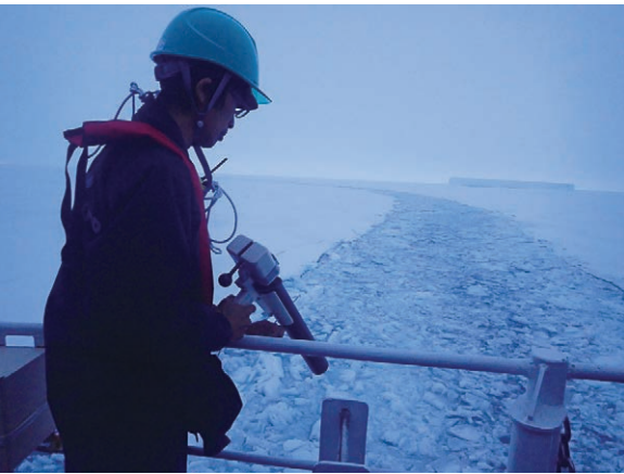
XCTD(投下式水温塩分計)の観測データは有線にて通信。その長さは最長約2km。
