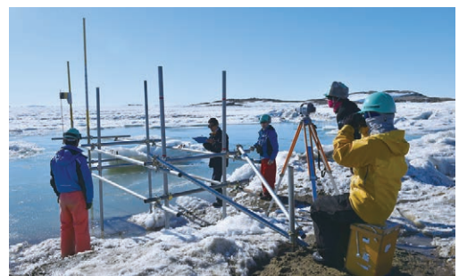
西の浦験潮所にある潮汐観測装置。他の隊員の協力を得て、初めて充実した観測が実現。
