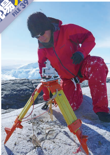
氷床変動測量。GNSS受信機で24時間データをとり続ける。これまでの観測で氷床は西北西の方向へ年間約5m動いていることが分かった。
