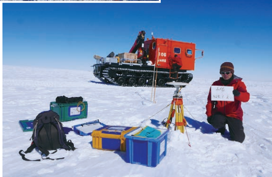
氷床変動測量。GNSS受信機で24時間データをとり続ける。これまでの観測で氷床は西北西の方向へ年間約5m動いていることが分かった。
