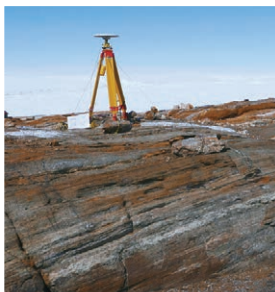
氷床変動測量。GNSS受信機で24時間データをとり続ける。これまでの観測で氷床は西北西の方向へ年間約5m動いていることが分かった。
