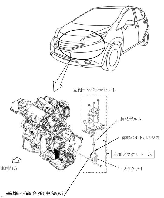
過給機付エンジンの左側エンジンマウントにおいて、ブラケットの締結ボルト用ネジ穴の加工が不適切なため、ネジ穴を二重に加工したものがある。そのため、CVTの駆動力等の振動により締結ボルトが緩み、そのまま使用を続けるとボルトが破断してエンジンが傾き、最悪の場合、ドライブシャフトが外れ、走行できなくなるおそれがある。
