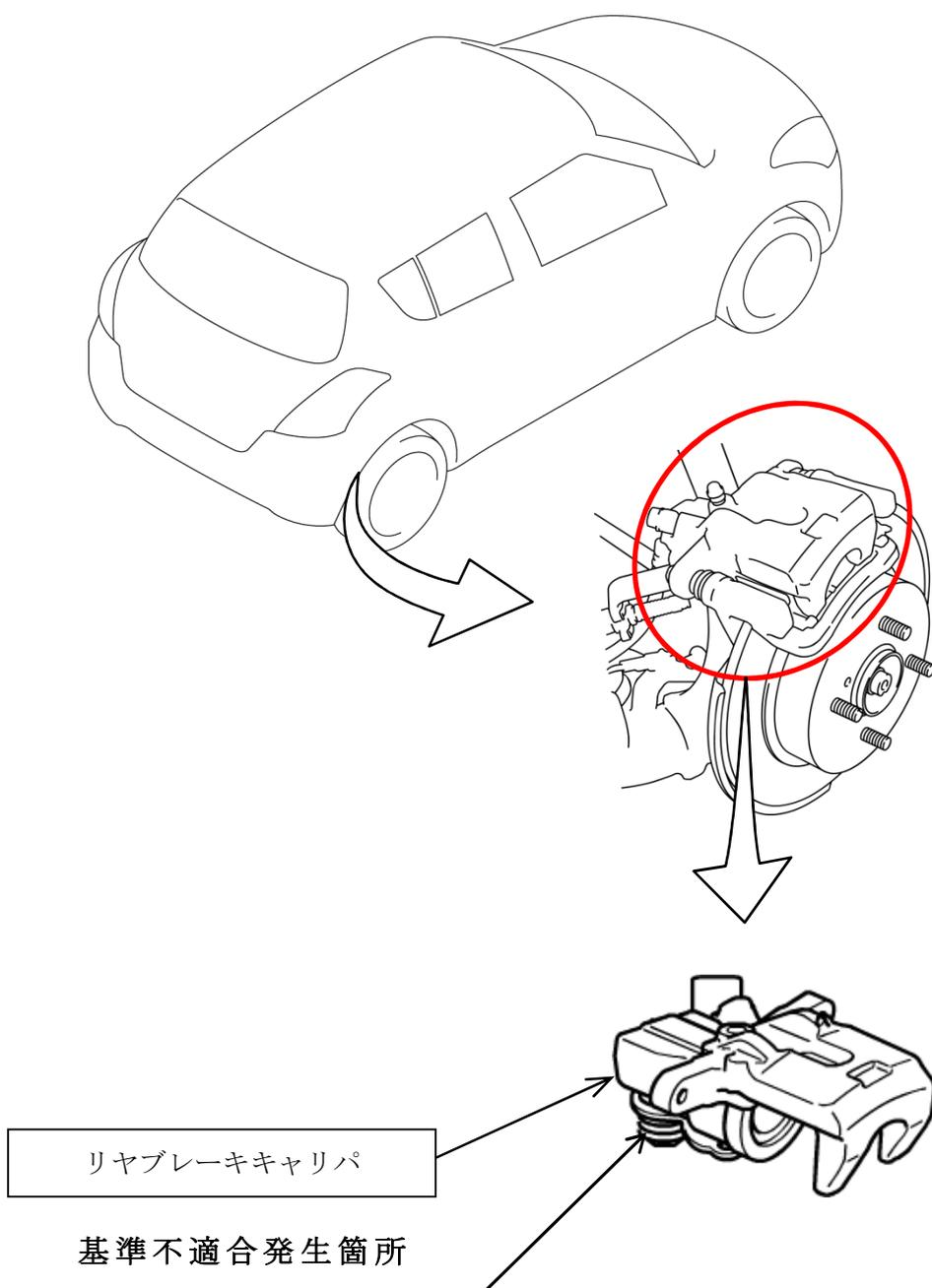
後輪のブレーキにおいて、キャリパの製造が不適切なため、駐車ブレーキ用ピストンが収まる部分のシリンダ内径が大きいものがある。そのため、キャリパ内部のシール性が低く、密閉が保てずブレーキ液が漏れて警告灯が点灯し、最悪の場合、制動力が低下するおそれがある。
