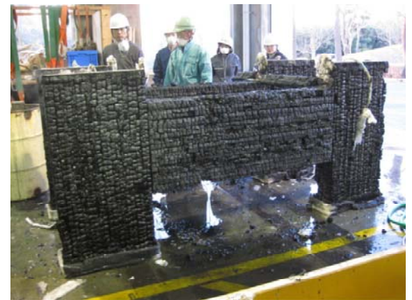
1時間加熱後の試験体の様子
