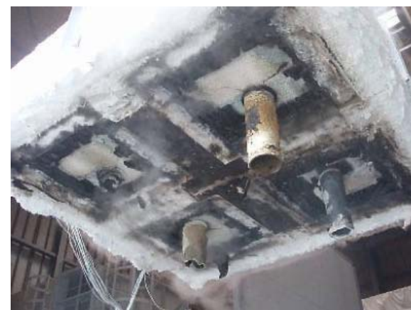
加熱後K1試験体
