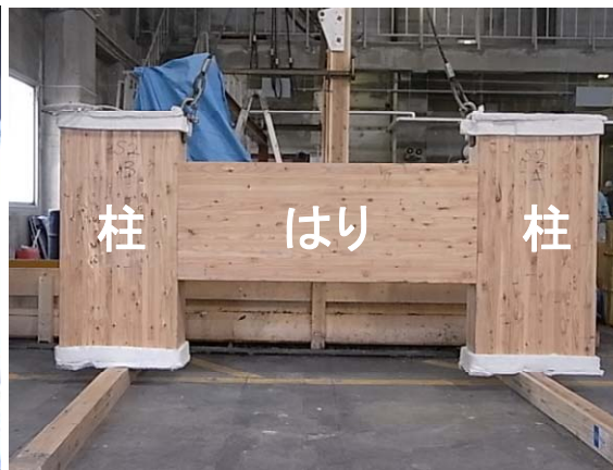
②柱-はり接合部試験体
