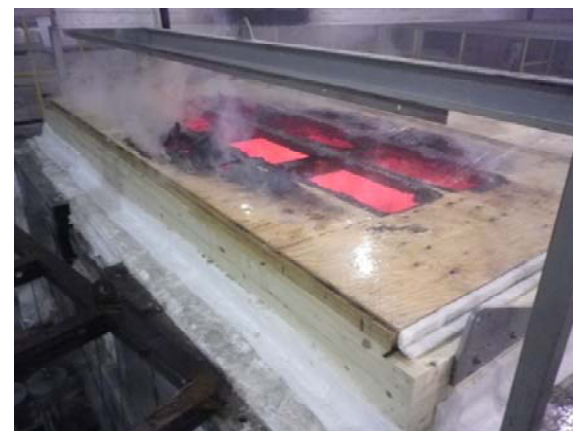
燃え抜け後の屋根試験体
