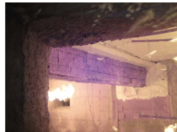
加熱中のはり試験体
