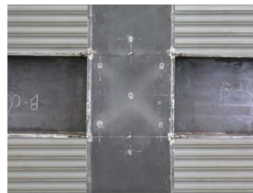
最終破壊状況(試験体 B-C-6)
