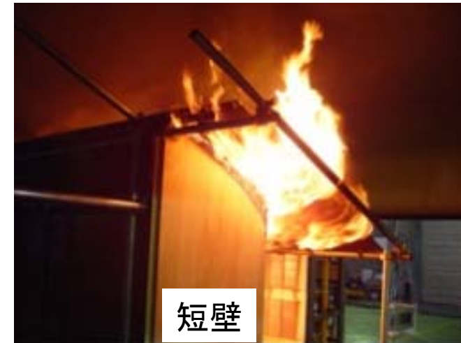
短壁への延焼(外部放射あり)
