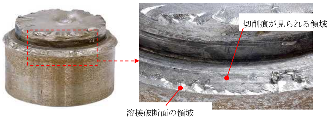
写真3 大径側の主軸破断部（溶接破断面拡大）
