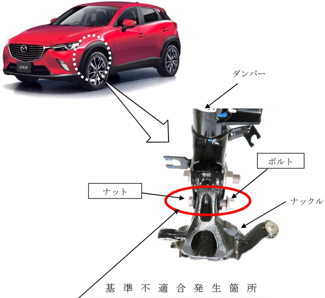
前輪サスペンションにおいて、ダンパーとナックルの締め付け作業が不適切なため、ナットの締め付け力が不足しているものがある。そのため、そのままの状態で使用すると、当該ナットが緩み、最悪の場合、ナットおよびボルトが脱落し、走行不能になるおそれがある。
