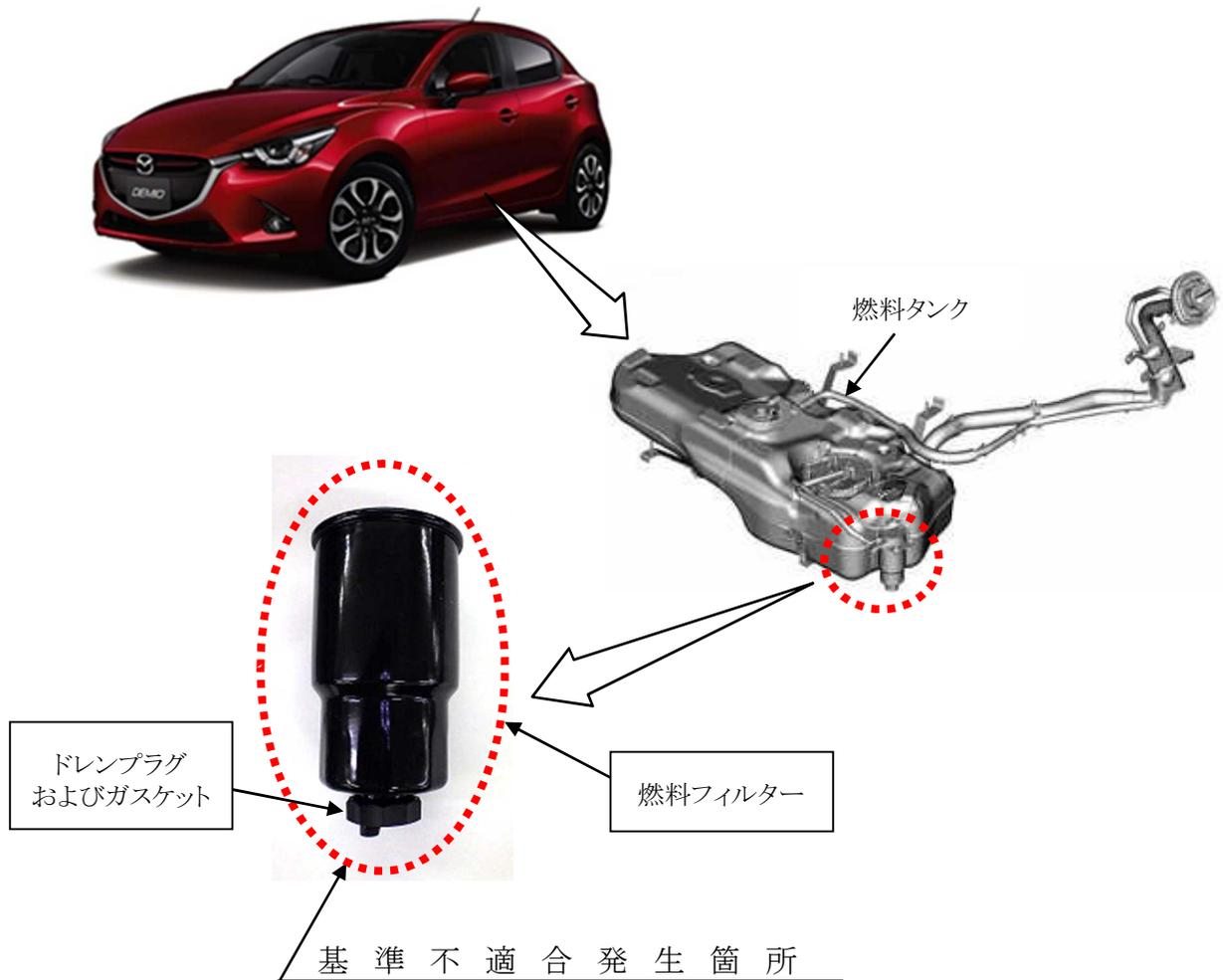
燃料フィルターにおいて、ドレンプラグ取付部の平面が確保できていないため、定期点検時にドレンプラグを緩め、再締め付け作業を行うと、シール性が低下することがある。そのため、そのまま使用を続けると、燃料が漏れるおそれがある。
