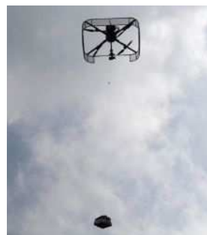
土砂サンプリング装置を吊り下げて飛行するマルチロータ機。
