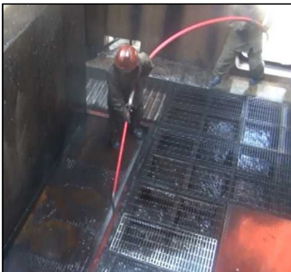
Step3 （中規模火災） アプリケーションノズルの水霧を下に向けてビルジ区画の冷却消火を実施する。
