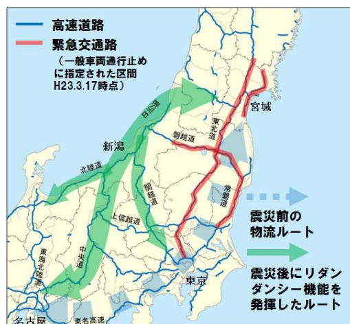
日本海側の幹線道路網が物資の輸送ルートとして機能 図12 東日本大震災における道路の役割
