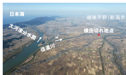
信濃川では、横田切れ、曾川切れなどの堤防決壊による大規模な河川氾濫が頻発していた。大正11年、大河津分水路の通水により、信濃川下流域の治水安全度は向上した。
