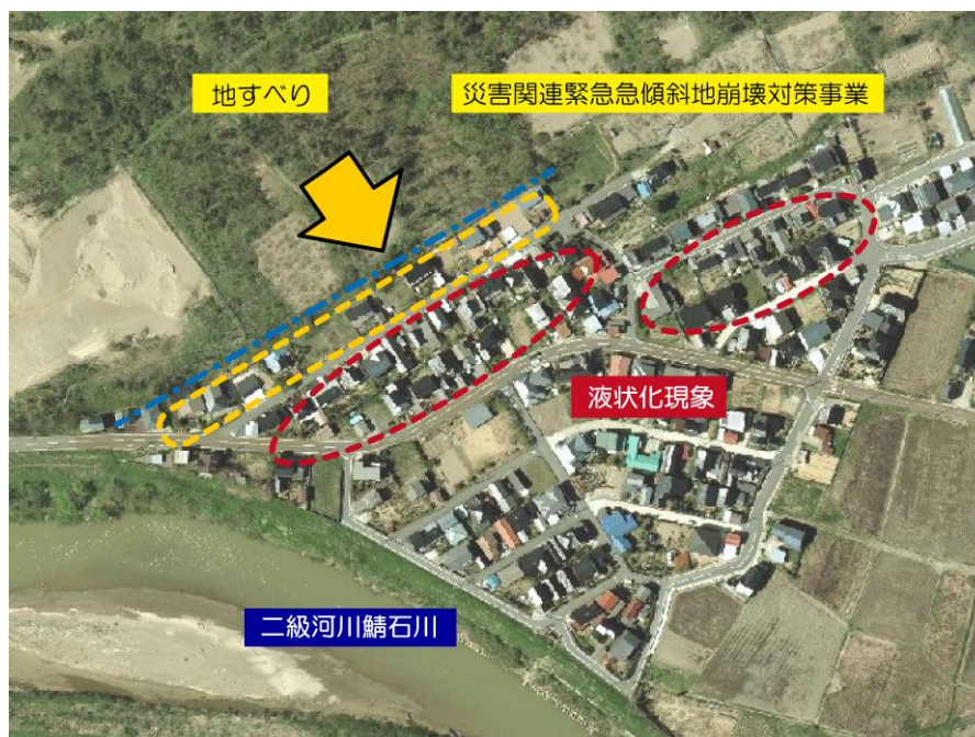
図-5 山本団地の被災概況
