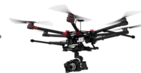
UAV【空撮→写真測量】
