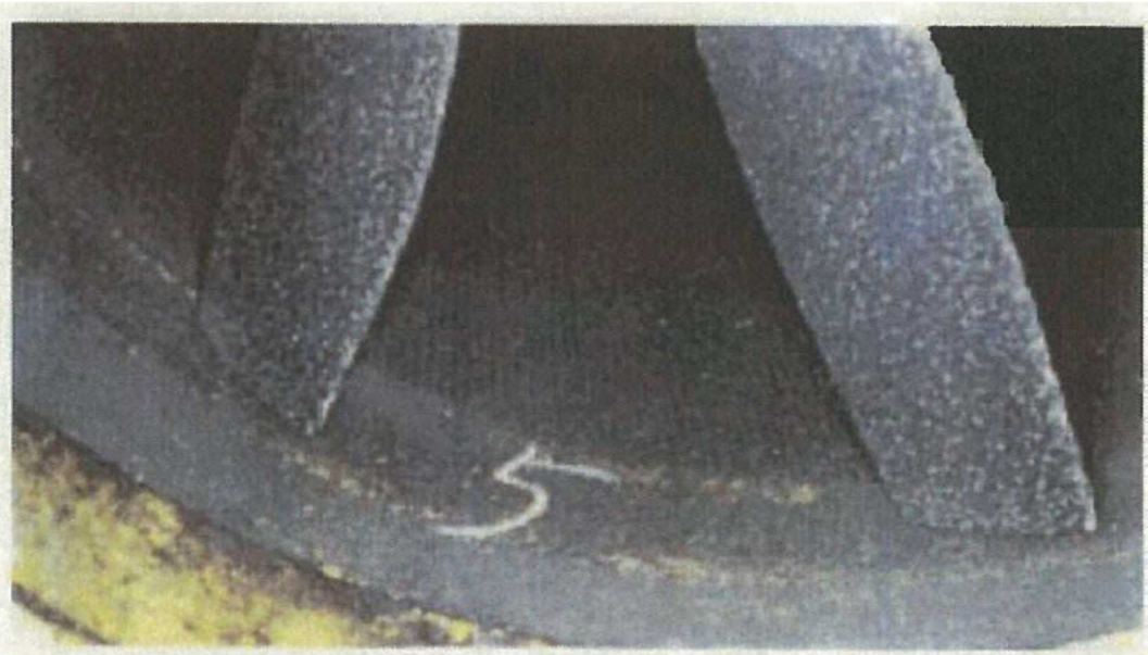
写真－６ 羽根車：ダスト付着 [有]
