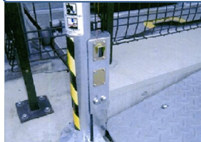
上段枠:操作盤 下段枠:侵入検知センサ 写真下:侵入検知センサ受側
