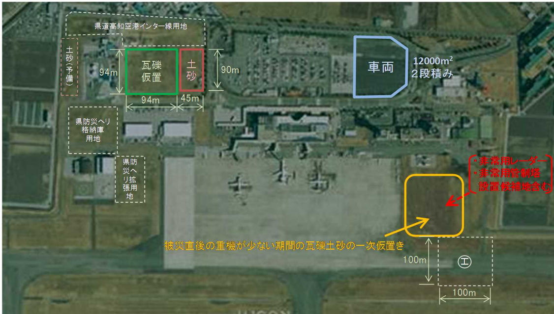
図 52 土砂・瓦礫・車両の仮置き場用地
