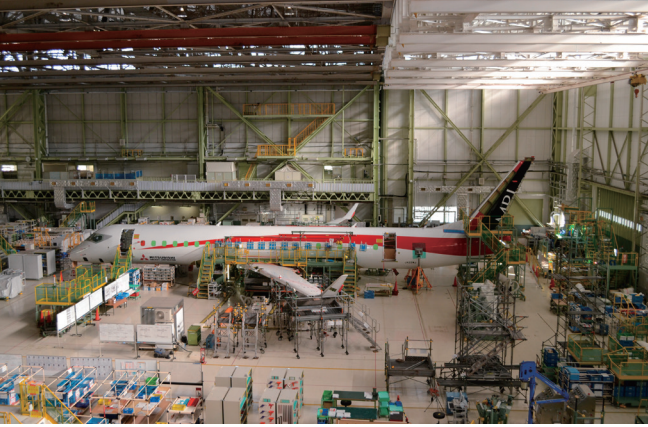
飛行試験機2号機の構造組み立て中の様子（平成26年9月）。胴体と主翼、胴体と垂直尾翼を結合しているところ。初号機は同年10月に完成し、機体を初めて一般公開した。
