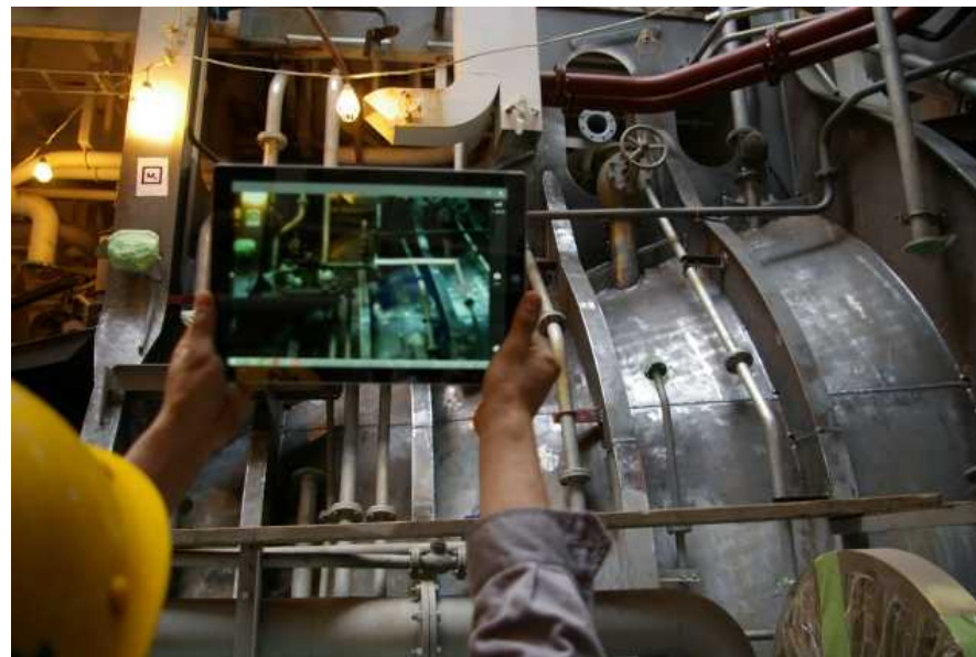
艀装作業支援ARアプリケーション
