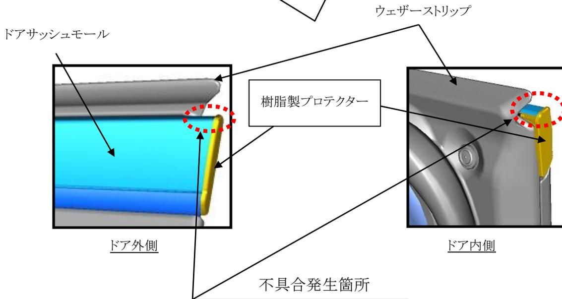
乗降口ドアのドアサッシュモールにおいて、乗降等のドア開閉時に当該ドアサッシュモール部に接触すると、モール端部の樹脂製プロテクターの角部または、当該プロテクターが外れ金属製モールの端部により、指等を切創するおそれがある。
