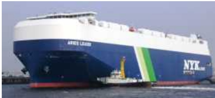
邦船社 7,000台積級 自動車専用船 「ARIES LEADER」(日本郵船) 総トン数:69,931トン 全長:199.98m 幅:35.80m 喫水:10.4m
