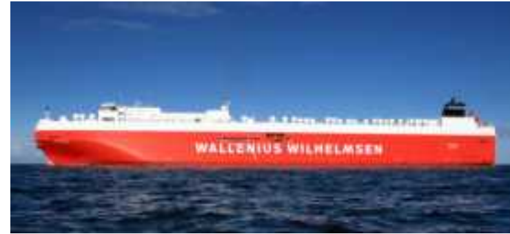
外船社 世界最大RORO船 「TONSBERG」(WWL) 総トン数:74,622トン 全長:265.00m 幅:32.26m 喫水:12.3m
