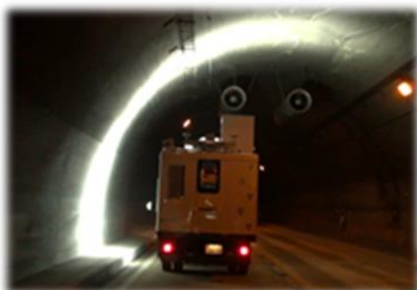
【車両走行型点検技術】
