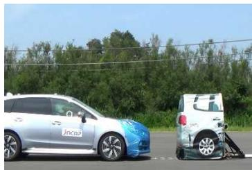
（衝突被害軽減ブレーキ試験の様子）
