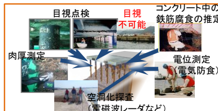
栈橋の点検診断
