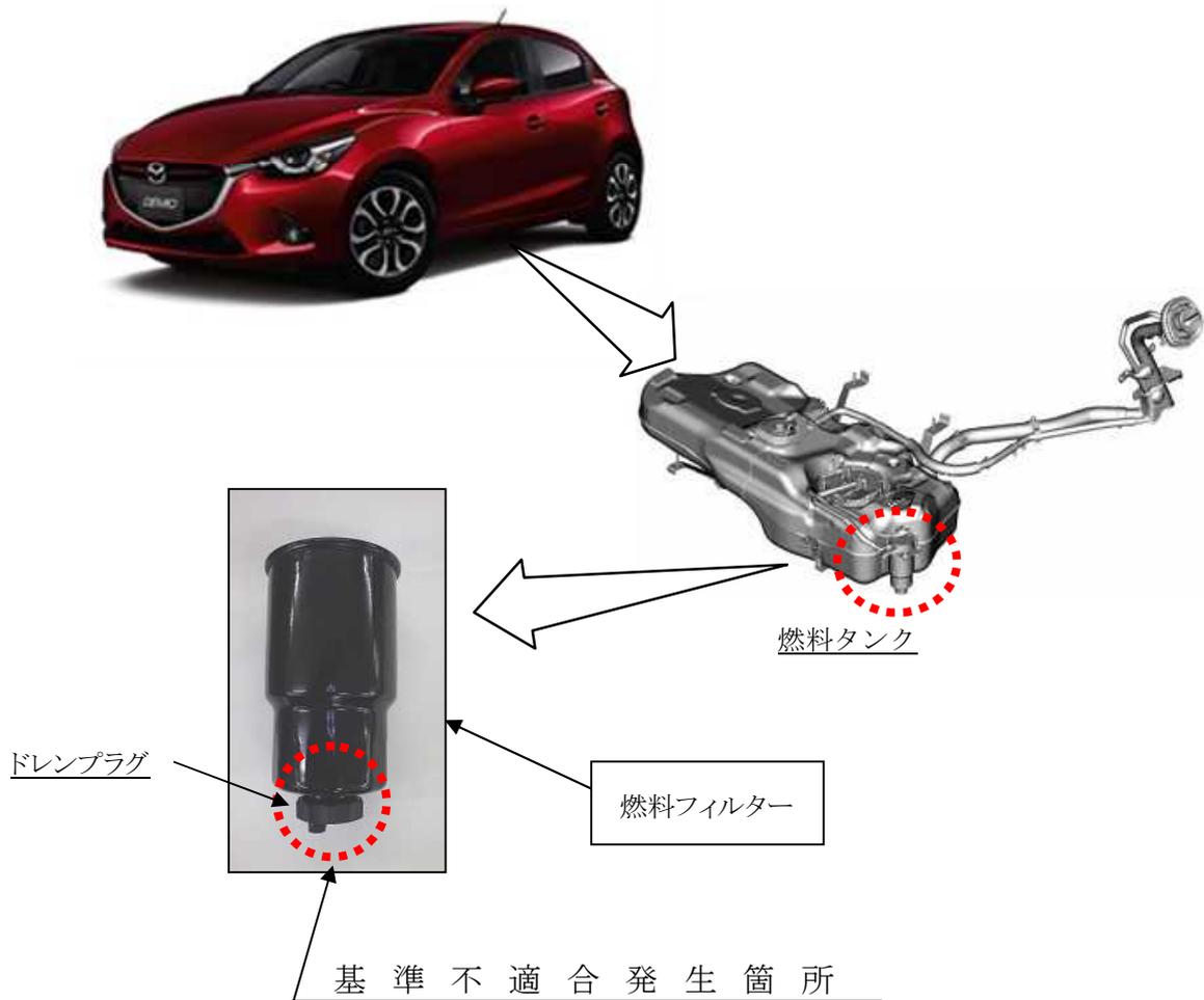
燃料フィルターにおいて、ドレンプラグ取付部の平面が確保できていないため、製造時に過大なトルクでドレンプラグを締め付けた場合に、ガスケットが変形もしくは圧縮割れが発生するものがある。そのため、そのまま使用を続けたり、定期点検時にドレンプラグを緩め、再締め付け作業を行うと、燃料が漏れるおそれがある。
