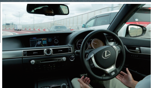
首都高速道路で2015年10月6日にトヨタ自動車(株)が行った自動運転車の走行実験の様子。各種のセンサーで周辺車向を検知し、高度な空間情報と人工知能を組み合わせ、合流や車線変更もすべて自動走行に成功した。
