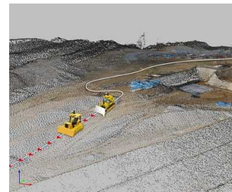
重機の搬入経路策定
