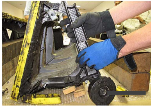
写真5 踏段 (No. 96) 右側の下部フレーム
