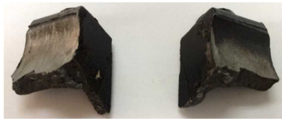
写真9 踏段 (No. 96) の把持部の破片
