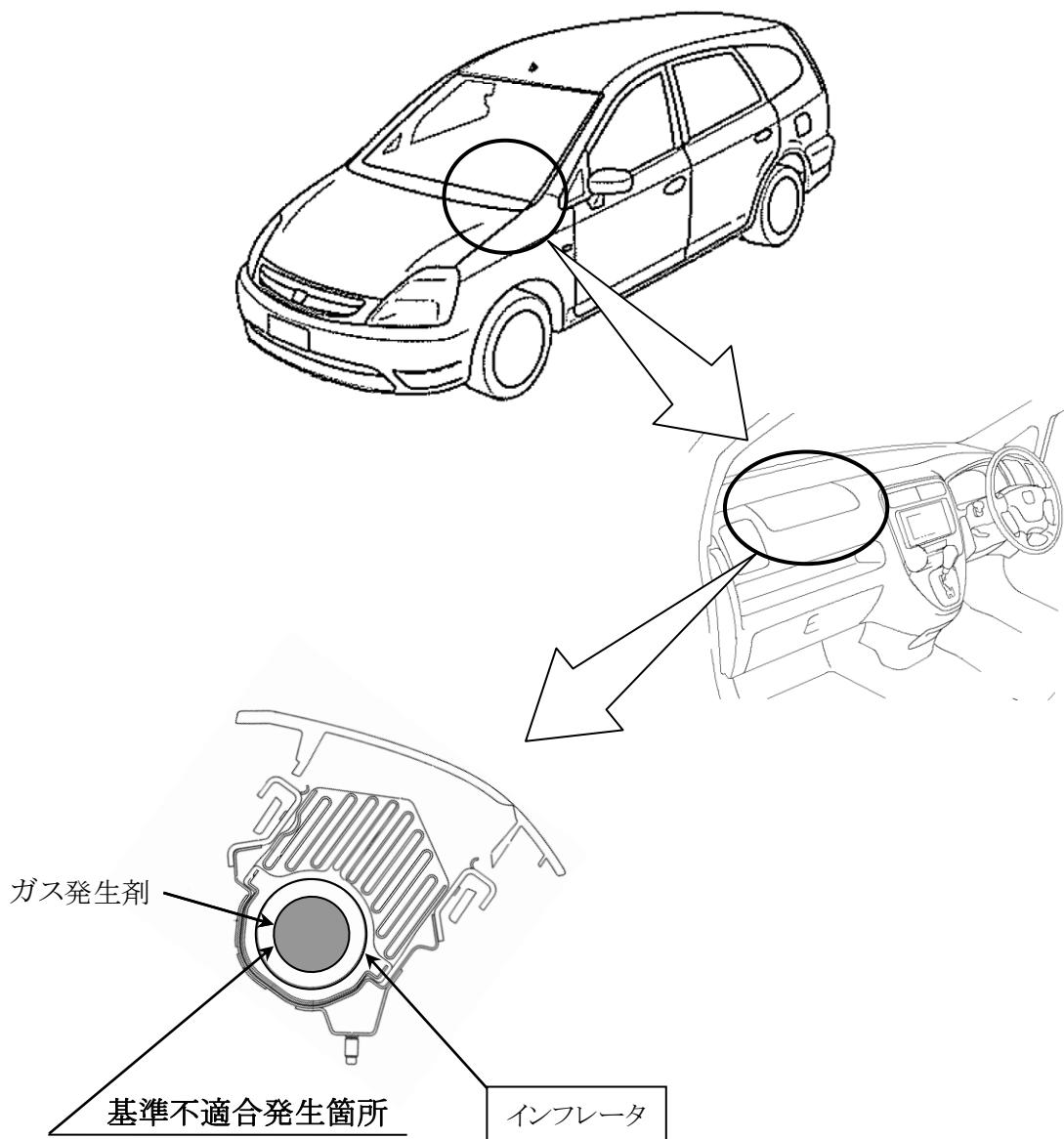
助手席用エアバッグのインフレータ（膨張装置）において、ガス発生剤の成型工程が不適切又は成型後の吸湿防止措置が不適切なため、密度が不足したガス発生剤が組み込まれたものがある。そのため、エアバッグ展開時にインフレータ内圧が異常上昇し、インフレータ容器が破損して飛び散り、出火したり乗員が負傷するおそれがある。
