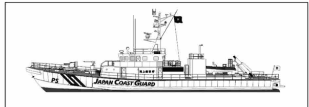
外国漁船の規制のために船体強度を高めた巡視船
