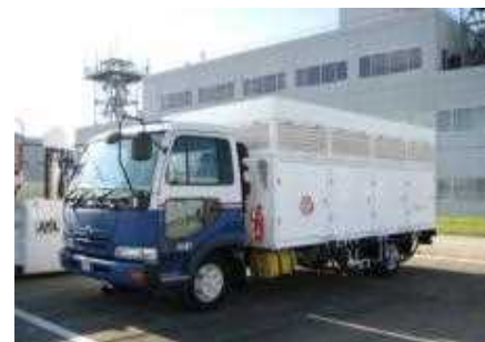
電源車(移動式インバータ)1台配備
