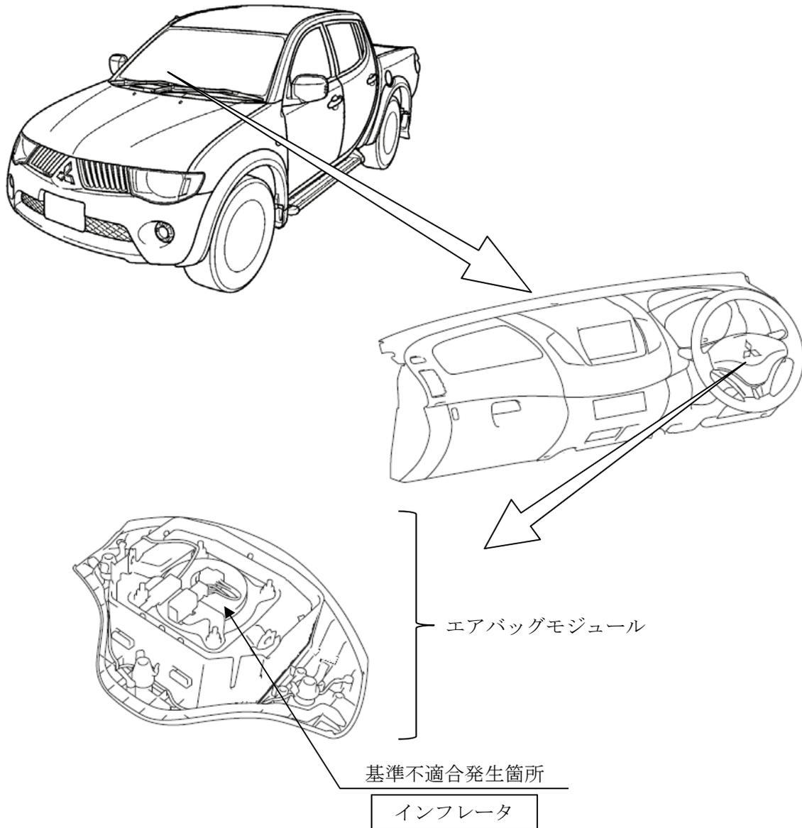
運転者席用エアバッグのインフレーター（膨張装置）において、他社で市場回収品を調査した結果、ガス発生剤の密度にばらつきが大きいものを確認した。このため、原因は判明していないが、エアバッグ展開時に正常に展開しないおそれがあることから、予防的措置として当該インフレーターを新品に交換する。
