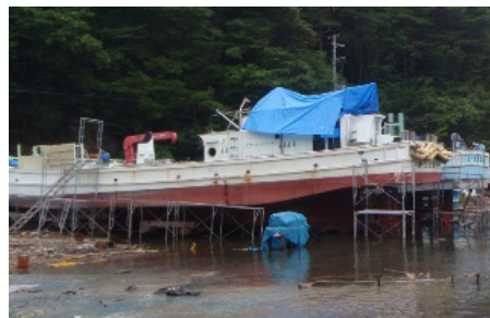
仮復旧による船の修理(大船渡地区)
