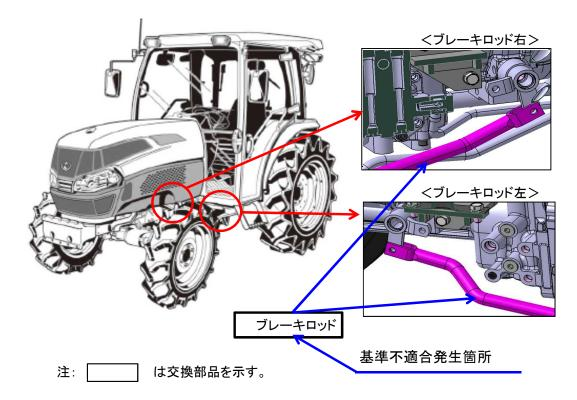
農耕トラクタの制動装置において、ブレーキロッドの形状が不適切なため、当該ロッドとクラッチハウジングケース及びパワーステアリング配管との隙間が狭いものがある。そのため、ブレーキペダルの遊び調整を行うと、隙間がさらに狭くなり、制動装置を作動させると、ブレーキロッドとクラッチハウジングケース及びパワーステアリング配管が接触するおそれがある。
